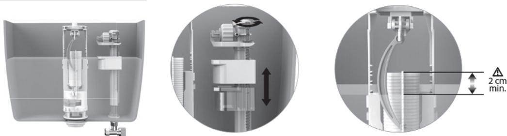
Régler le niveau d'eau à l'aide de la vis de réglage. Visser pour augmenter, dévisser pour diminuer le niveau.
